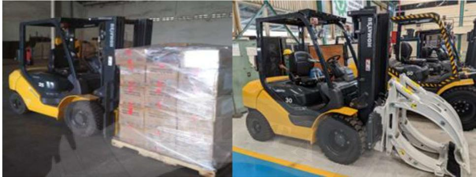
**Gambar 1.8** *Forklift* dengan *attachment fork* (kiri) dan *forklift* dengan *attachment paper rollclamp* (kanan)
