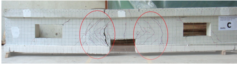
Gambar 1.1 Pola retak dan keruntuhan balok beton bertulang dengan bukaan di daerah M_{maks} Catatan: Gambar diperoleh dari Laporan Penelitian No. P-006-FDTP/VI/2007
