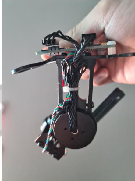
Gambar 4.12 Pemasangan brushless motor pada badan
