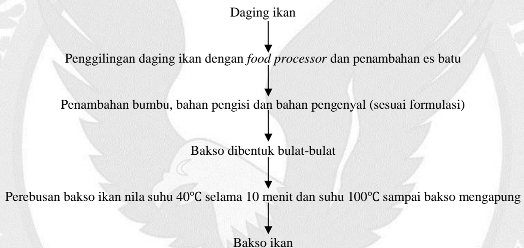
Gambar 3. 3 Diagram alir pembuatan bakso ikan dengan rasio tepung tapioka dan glukomanan umbi porang
