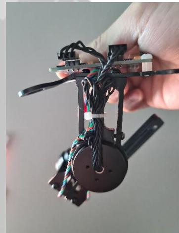
Gambar 4.12 Pemasangan brushless motor pada badan
