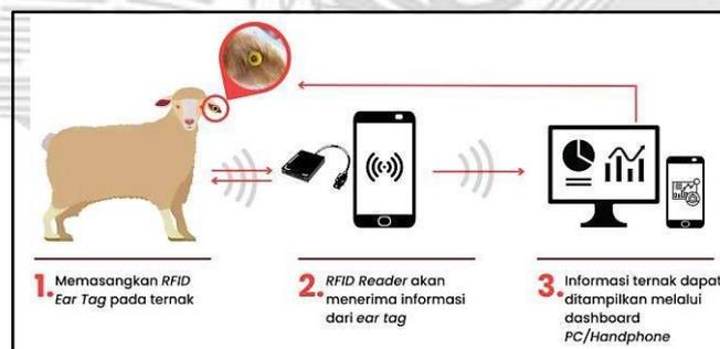
Gambar 1.1. Ilustrasi Implementasi *RFID Ear Tag* pada Ternak
